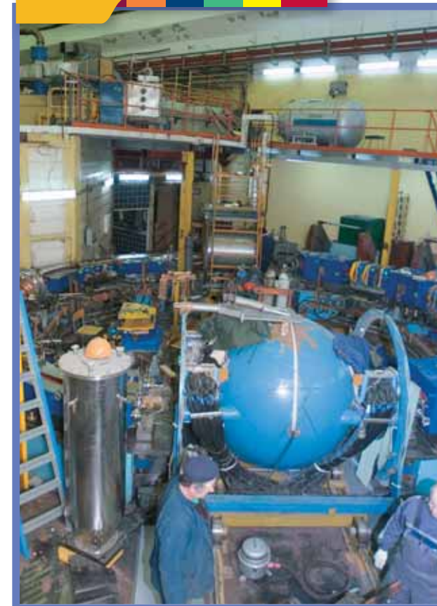
Бустерный синхротрон Б-4, где происходит предварительное ускорение электронных (позитронных) пучков до энергии инжекции (360 МэВ) в накопитель ВЭП-3
