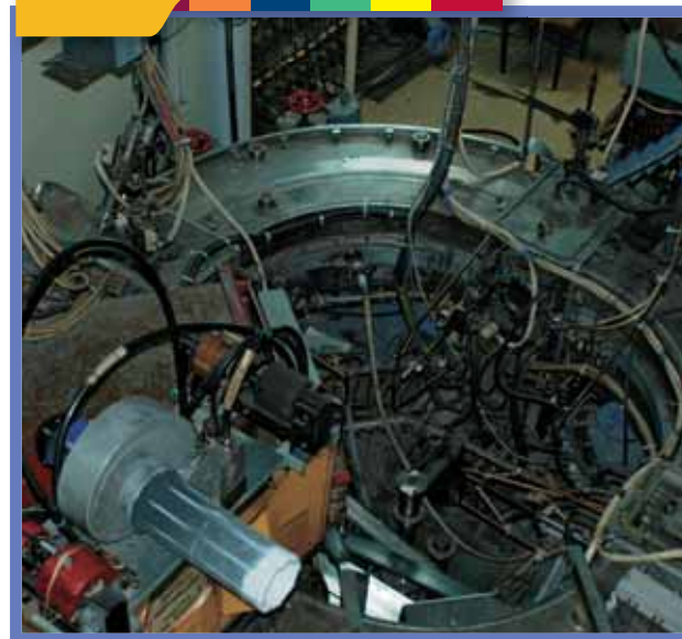
Бустерный синхротрон Б-4, где происходит предварительное ускорение электронных (позитронных) пучков до энергии инжекции (360 МэВ) в накопитель ВЭП-3
